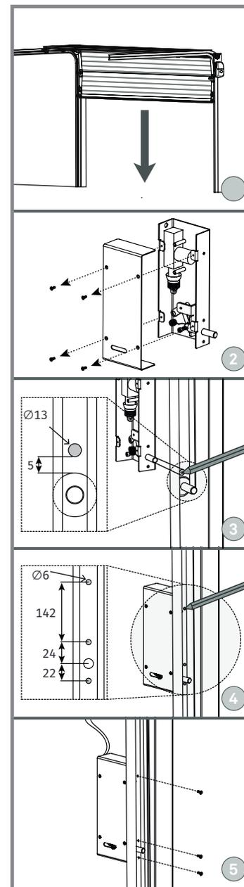
1 • Cierre la puerta para determinar el local de instalación (img. 1).
