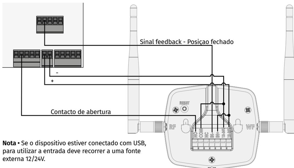
**Nota** • Se o dispositivo estiver conectado com USB, para utilizar a entrada deve recorrer a uma fonte externa 12/24V.
