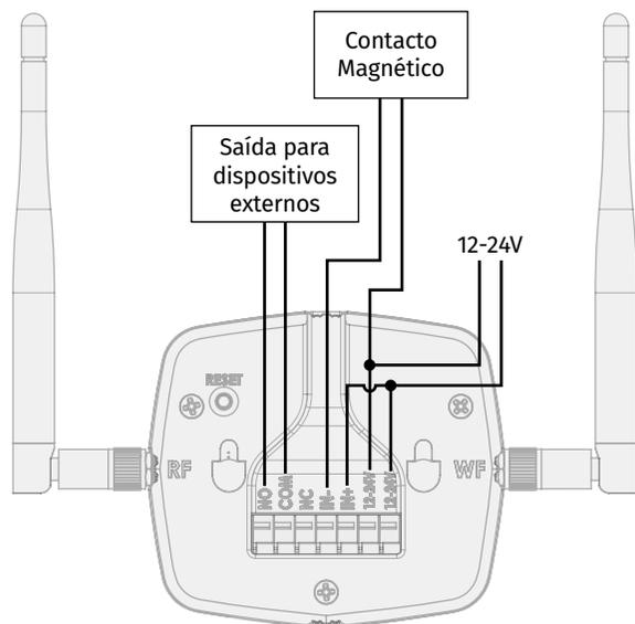
**Nota** • Se o dispositivo estiver conectado com USB, para utilizar a entrada deve recorrer a uma fonte externa 12/24V.
